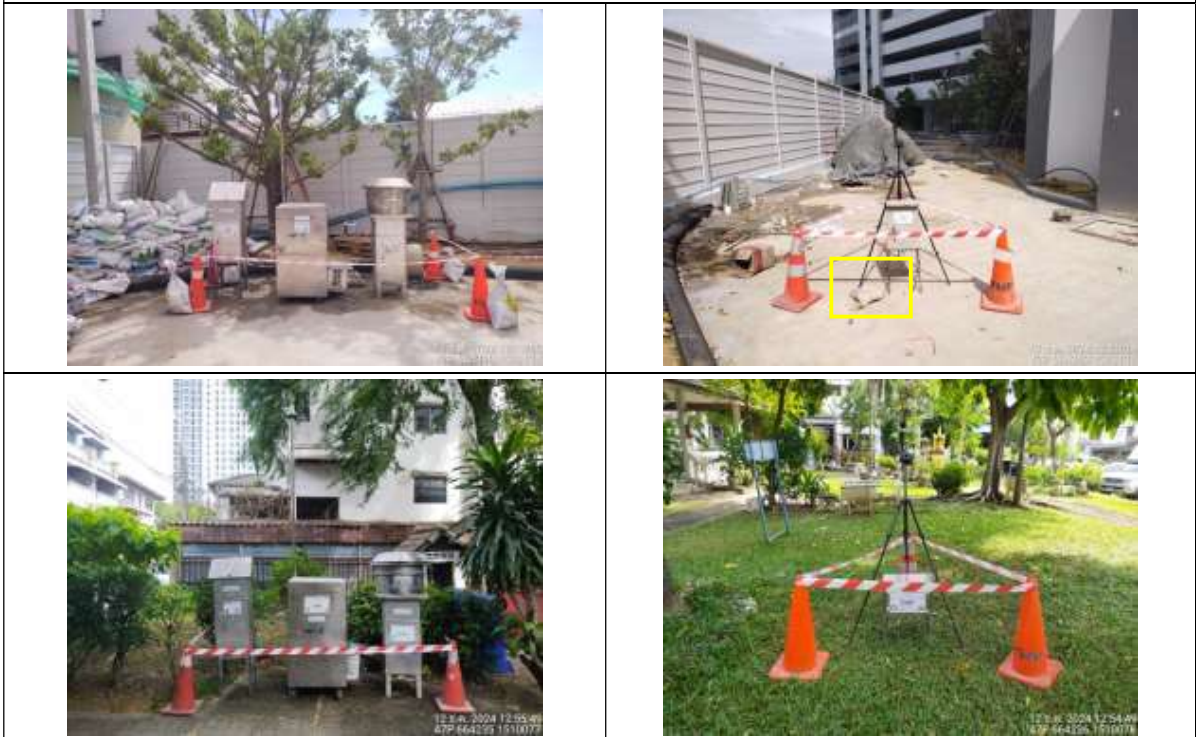
รูปที่ 68 ติดตั้งเครื่องตรวจวัดคุณภาพสิ่งแวดล้อม (คุณภาพอากาศ ระดับเสียง เสียงรบกวน และความสั่นสะเทือน)
